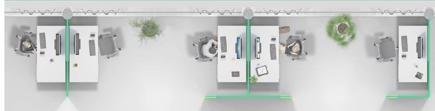
Glastrennwandsystem kombiniert mit Nahfeldschirmung durch Wandpaneele
