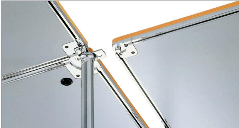
Der patentierte Eckbeschlag der Systemtische ist das Herzstück von Contas: Die Verbindungsplatte lässt sich einfach ausschwenken, um eine oder auch zwei Einhängelplatten aufzunehmen. Dadurch können komplexe Tischanlagen schnell und werkzeugfrei aufgebaut, verändert und wieder demontiert werden.
