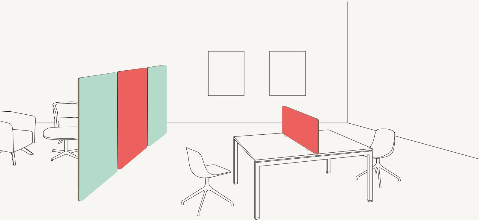
Le traitement acoustique commence au plus près de la source : sur le bureau, dans les zones de passage... **Composés d'une âme isolante revêtue de part et d'autre d'une mousse de mélamine à fort pouvoir d'absorption, les écrans MADISON réduisent les nuisances sonores de poste à poste. Les cloisons délimitent des zones calmes au sein des espaces ouverts.**
